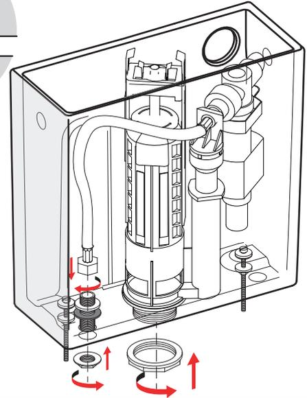
Aprire il foro predisposto per l'alimentazione dal basso e posizionare le viti di fissaggio
