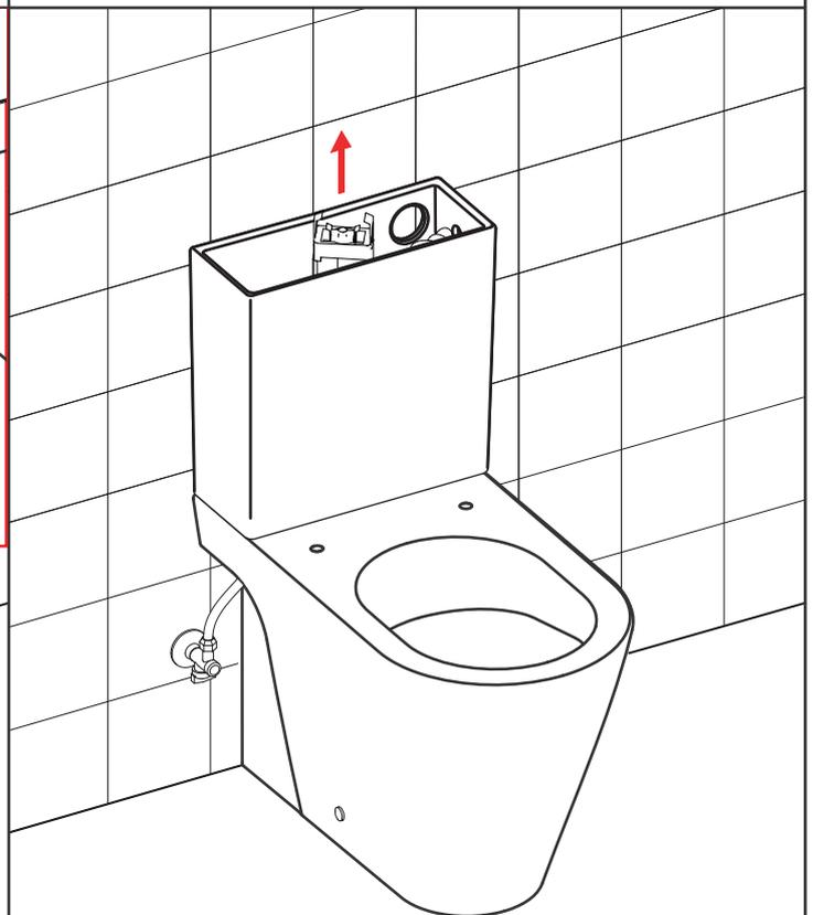
Dopo aver installato il tubo di alimentazione sulla cisterna, collocarla sul w.c. e serrare le viti di fissaggio
