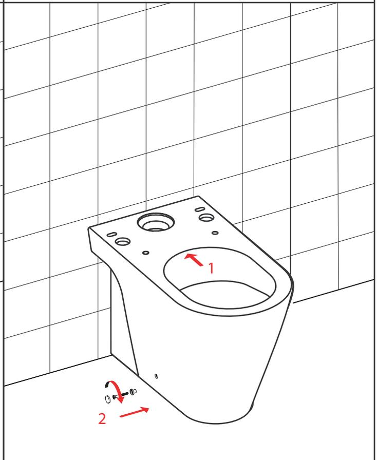
Posizionare il WC e fissarlo con la minuteria in dotazione
