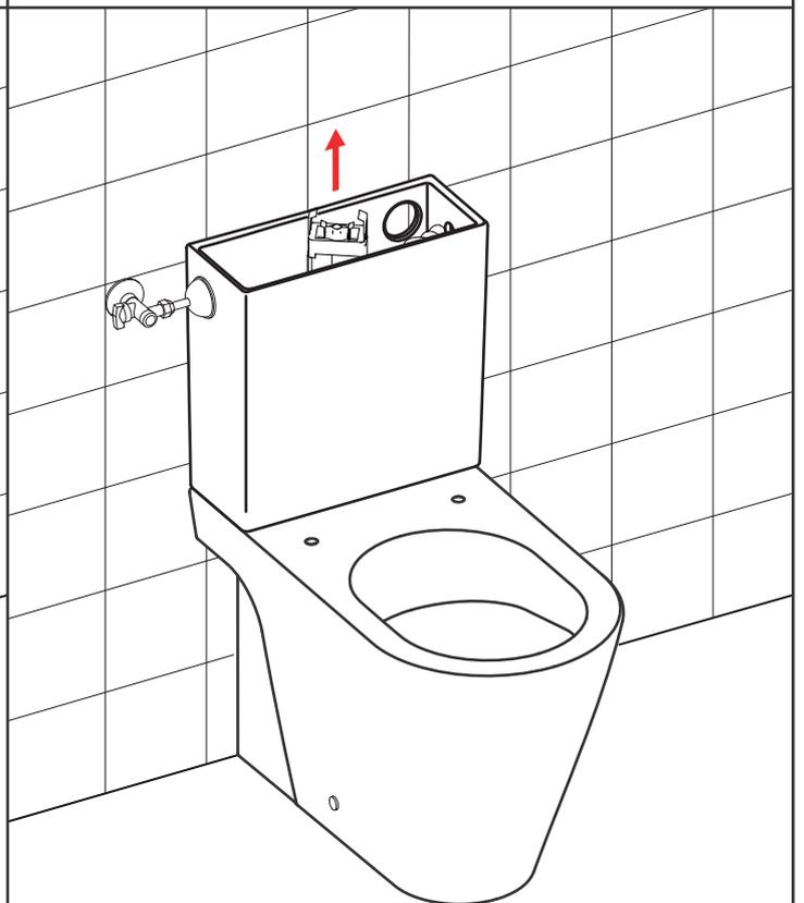
Collocare la cisterna sul w.c. e serrare le viti di fissaggio
