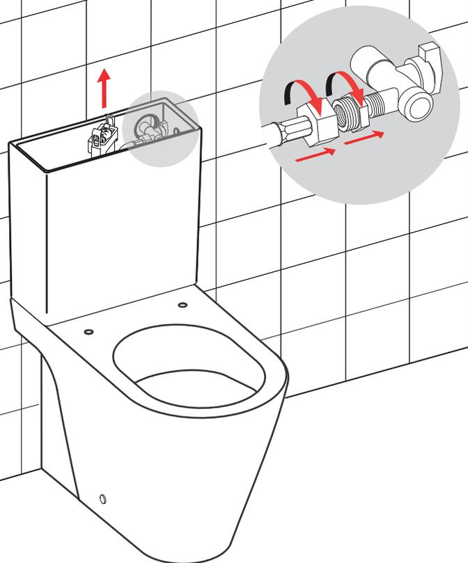
Regolare l'altezza del meccanismo per il serraggio del pulsante e realizzare i raccordi idraulici
