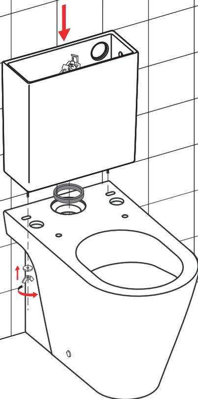
Collocare la cisterna sul w.c. e serrare le viti di fissaggio
