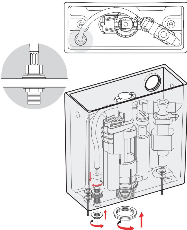
Aprire il foro predisposto per l'alimentazione dal basso e posizionare le viti di fissaggio
