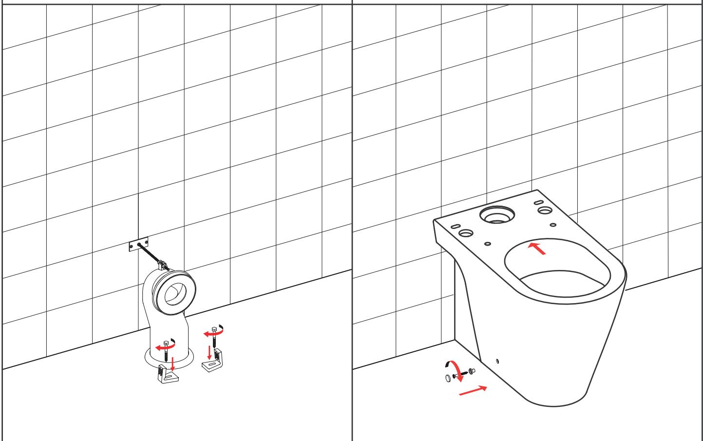
Ancorare i fissaggi al pavimento
