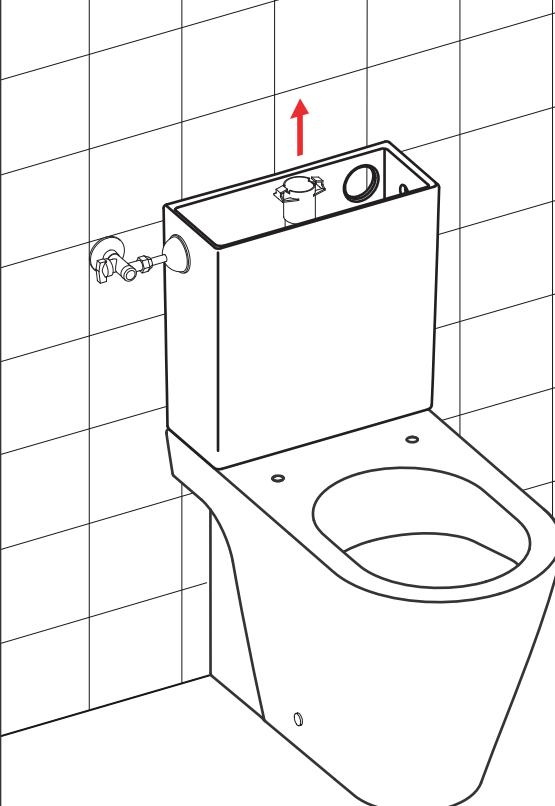
Collocare la cisterna sul w.c. e serrare le viti di fissaggio
