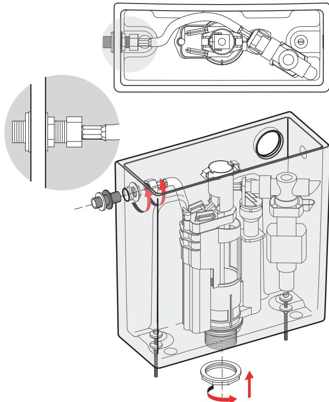
Aprire il foro predisposto per l'alimentazione laterale alta e posizionare le viti di fissaggio
