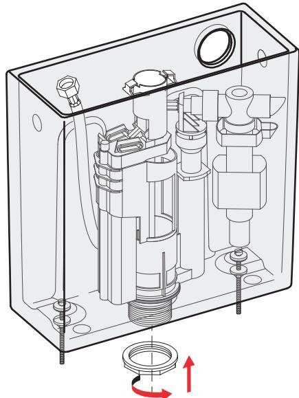
Posizionare le viti di fissaggio
