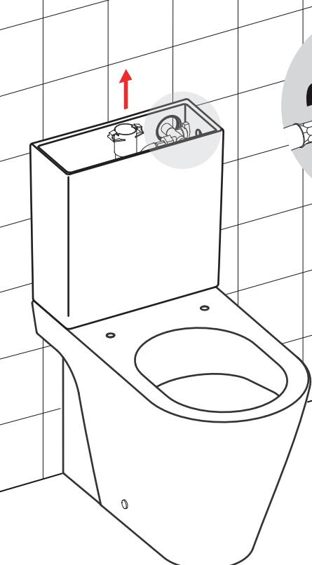
Collocare la cisterna sul w.c. e serrare le viti di fissaggio
